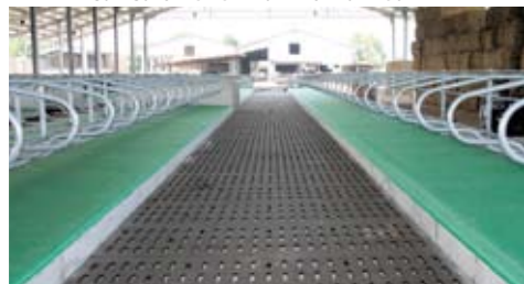
CUCETTE PREFABBRICATE PER MATERASSINO CON CORSIA GRIGLIATO RIVESTITO IN GOMMA
